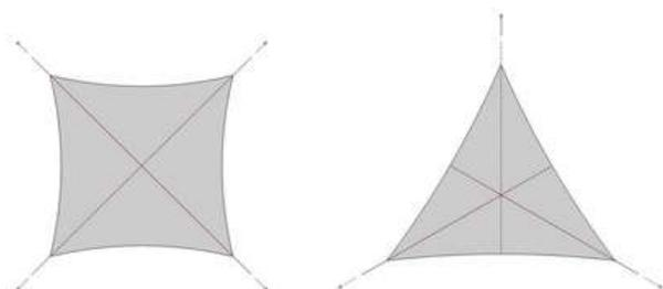
Les axes de tension correspondent aux **diagonales pour les quadrilatères** et aux **médianes pour les triangles**. Il faut également prévoir une **distance de tension de minimum 45cm** dans la continuité de ces axes (**ou selon les éléments fournis pour les projets sur-mesure**).
