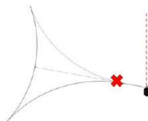
Dans le cas d'une installation avec 2 voiles accrochées sur un même mât, la rainure frontale du mât est au centre des 2 axes de tension.
