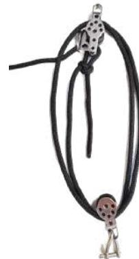
6°) Je passe la corde dans la poulie double avec taquet coinceur puis dans le taquet => Montage terminé (système de tension à installer avec le mousqueton fourni avec la voile).
